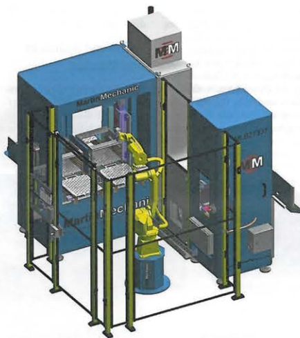
Im Bild die Automationszelle MLB27337 von Martin Mechanic zum Tiefengravieren von Ventilen. Ein Fanuc-Roboter vom Typ M101A holt sich aus zwei elektrisch angetriebenen Speichertürmen die Bauteile und belädt den Werkstückträger. Foto: Martin Mechanic
