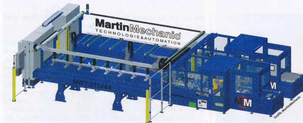
Die vollautomatische Leisten-Trennanlage MWT 211444 von MartinMechanic ist unter anderem mit zehn Robotern, acht Flächensaugern und vier Förderbändern bestückt
