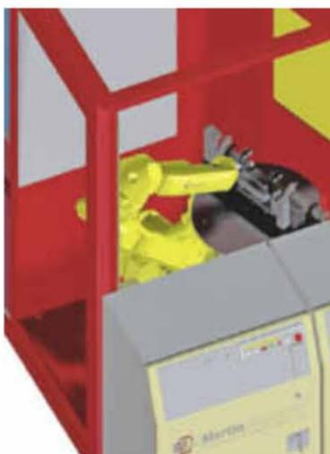
*Auf der Anlage wird ein Edelstahl-Verstärkungsrohr mit Halterungen und Laschen bestückt*
