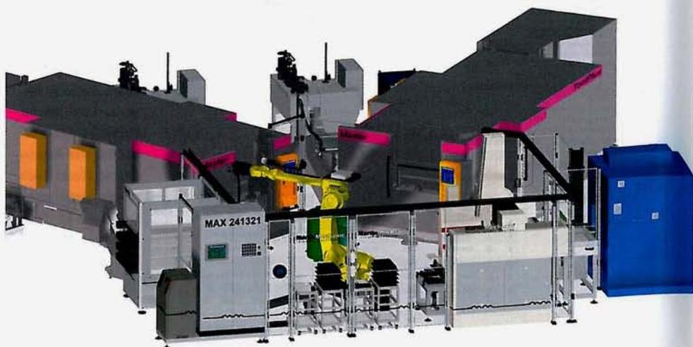
Der Roboter in der neuen Fertigungsinsel Max 241321 bedient sieben Stationen gleichzeitig
