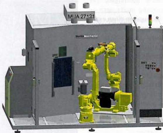
In der neuen Zelle wird auf einem Drehkipptisch geschweißt, der sich um eine Hoch- und eine liegende Achse drehen kann. Bild: MartinMechanic
