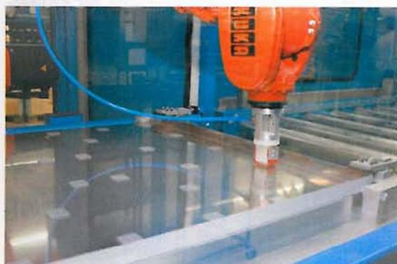
**Der Fügestempel des zweiten Roboters zieht die drei mal drei Zentimeter großen Klebepads von einer Kleberolle ab und setzt sie millimetergenau auf die passende Stelle des Blechs. (Fotos: MartinMechanic)**
